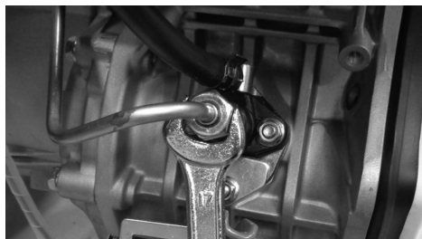
Рис. 12 Удаление воздуха из топливного насоса
