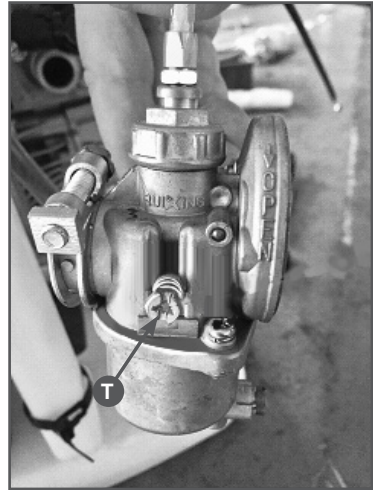
Рис. 16 Расположение винтов регулировки карбюратора
