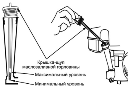
Рис. 9 Проверка уровня масла в картере
